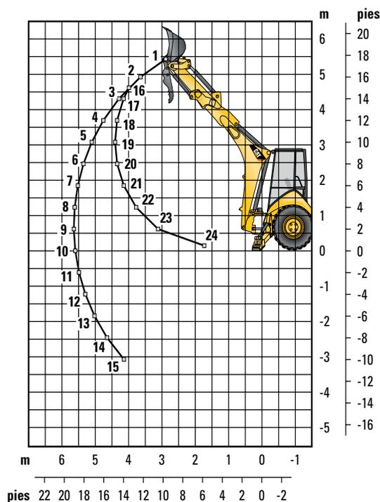
Las capacidades de levantamiento son valores de capacidad más allá del extremo de la máquina. Máquina equipada con tracción en las 4 ruedas, estructura OROPS, cucharón de uso general de 0,96 m<sup>3</sup> (1,25 yd<sup>3</sup>) y sin contrapeso. El brazo extensible incluye un contrapeso de 460 kg (1.015 lb).
